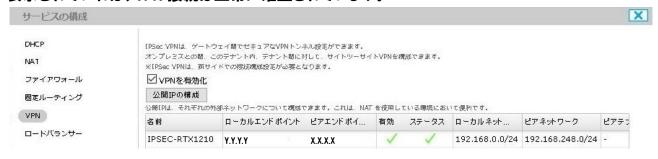
以下のように、「ステータス」表示に異常を示す赤色のマークが表示されている場合は、RTX1210、 もしくはホワイトクラウド ASPIRE の VPN 設定に誤りがないかを確認して下さい。(※1) VPN 確立先のアドレスや VPN 接続対象 NW、暗号化設定(事前共有キーやアルゴリズムの選択)に 誤りがある場合、VPN 接続が正常に確立できません。
