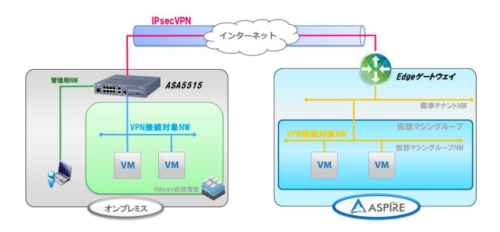
次項より記載する構成手順は、上図のうち IPsec VPN 以外の部分が構成された状態を前提としております。本資料の作成にあたり使用した機器、OS バージョンは、下記となります。
