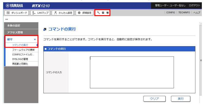
(2). 作成したコマンドをコピーし、「コマンドの入力」に貼り付け、「実行」をクリックします。
