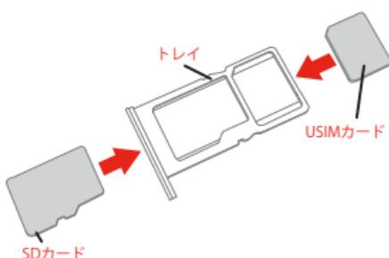
ステップ3. USIM カードとSDカードの金属端子面を下に向け、トレイの形にあわせて置きます。
