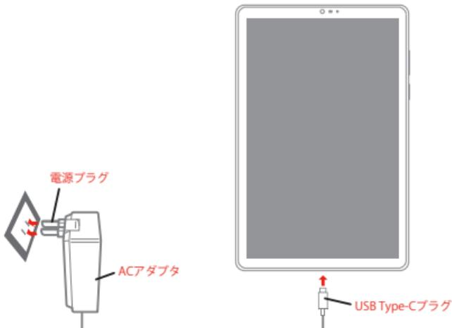
本体のUSB Type-C接続端子にACアダプタのUSB Type-Cプラグを接続し、電源プラグをコンセントに接続します。
