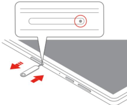
ステップ1. ディスプレイ側を上にして、USIM／SDカード用トレイ取り出し用の穴(○の位置)に、USIM／SDカード取り出しツールの先を差し込みます。
