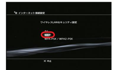
**9** ○ボタンを押してWEPキーを正しく入力し、方向キー「▷」を押します。
